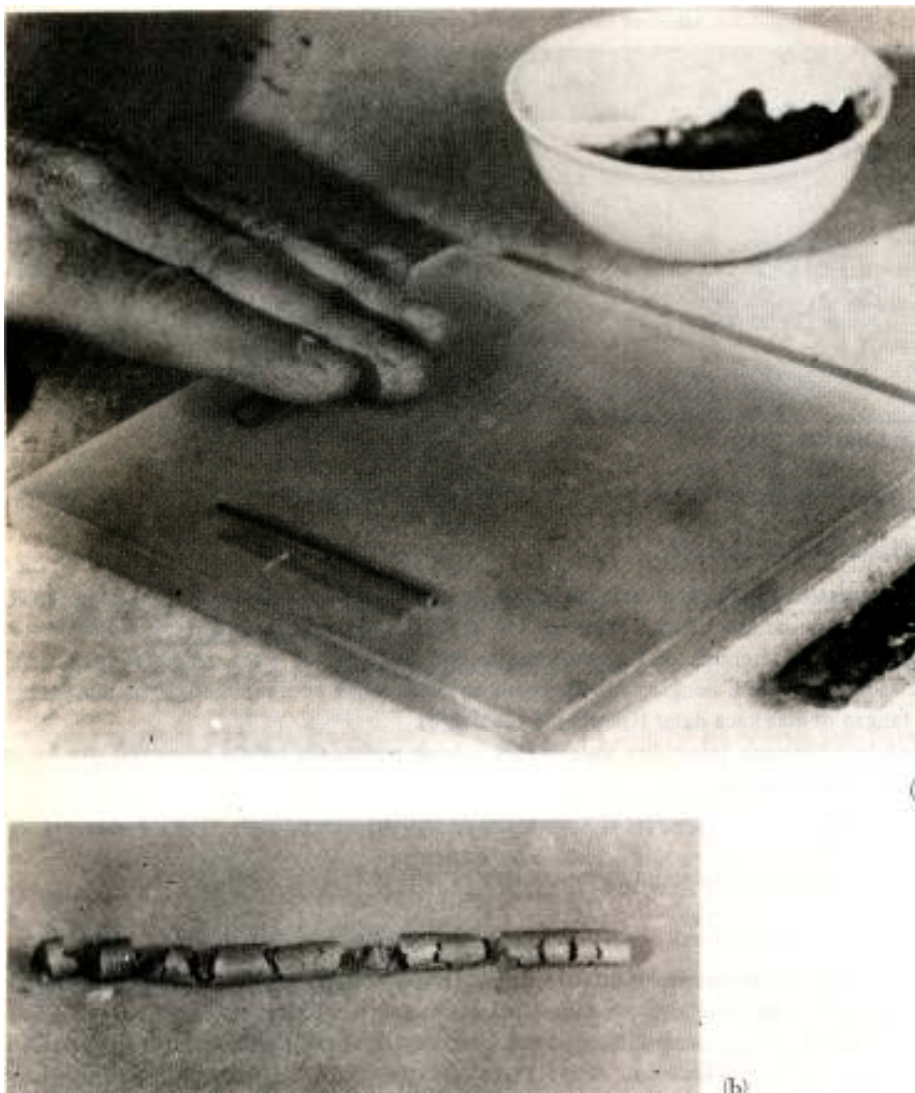
Gambar 3.5 Uji batas plastis : (a) contoh tanah yang sedang digulung; (b) gulungan tanah yang retak-retak (atas jasa dari Soiltest, Inc, Evanston, Illinois).
