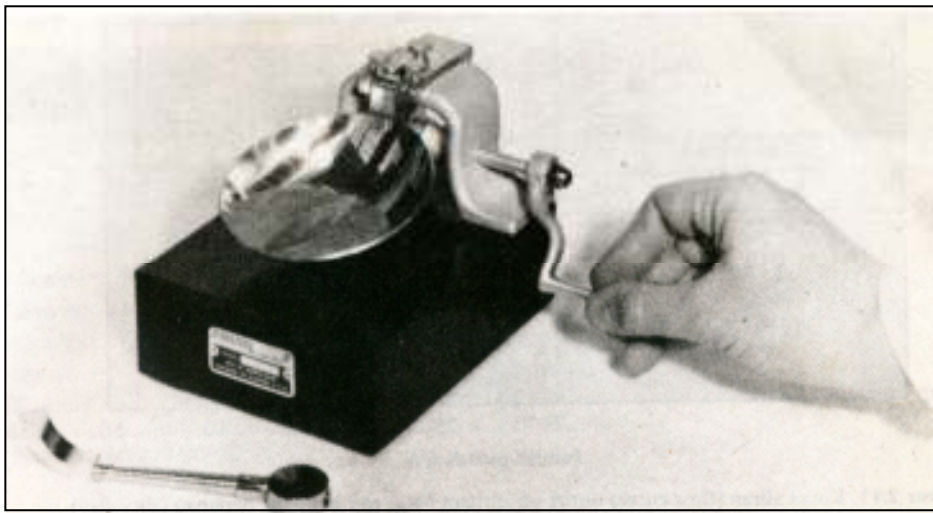
Gambar 3.2. Uji batas cair : (a) alat untuk uji batas cair; (b) alat untuk menggores; (c) contoh tanah sebelum diuji; (d) contoh tanah setelah diuji
